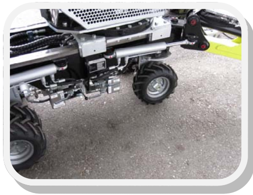
Mogućnost uklanjanja jednog reda kotača – manja transportna širina
