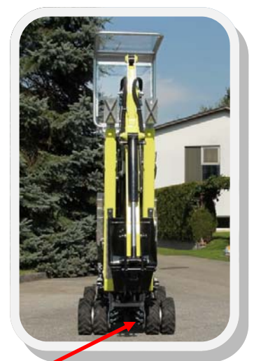
Teleskopsko podvozje - zbog veće stabilnosti u transportu
